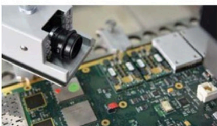
Surveillance des processus en direct sur le HR 600 XL
