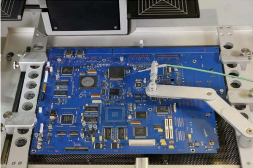
Traitement d'un assemblage dans le HR 550
