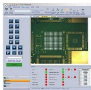
Superposition de la position du composant et de la cible
