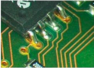
Assemblage sans plomb : non mouillant
