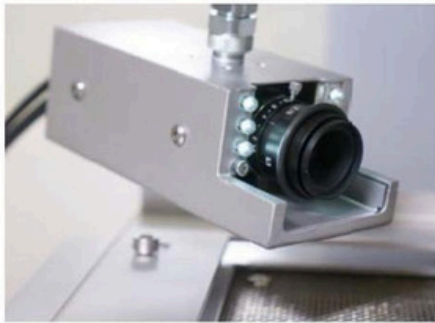
Caméra de traitement par refusion (RPC) sur le HR 550
