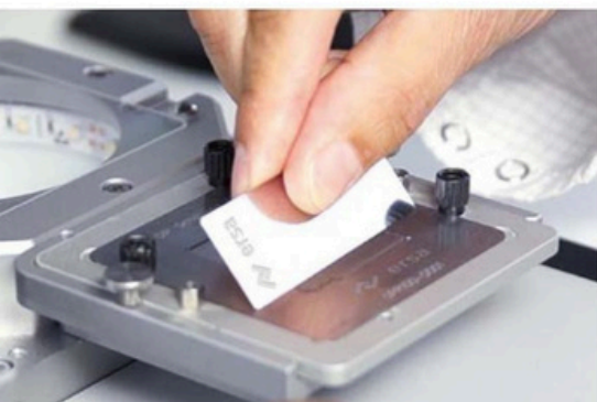
Dépôt de flux dans le pochoir par immersion
