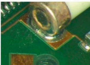
Assemblage sans plomb : non mouillant
