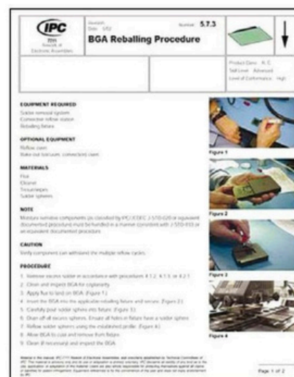
Systèmes de retravail Ersa recommandés pour le reballage BGA (source IPC 7711)
