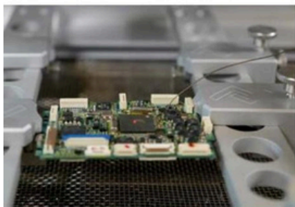
Les supports de carte flexibles s'adaptent à la taille et à la structure d'un assemblage.
