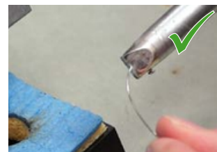
Ajoutez immédiatement une nouvelle soudure
