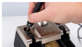
Changement de pointe ultra rapide : à la main ou à l'aide du porte-outil 0A58 compatible avec i-TOOL TRACE et tous les fers à souder de la série i-TOOL MK2.
