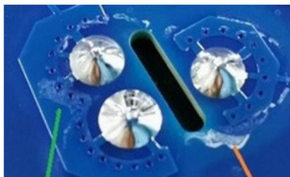
*le résidu du flux autour des joints de soudure, typique pour le brasage sélectif, peut être éliminé avec le SelectIF 2040 en utilisant la quantité de flux optimale*
