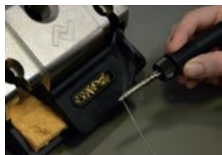
Ajouter une nouvelle soudure après le nettoyage
