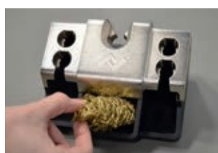
Retirez la laine métallique sale et videz le bac de récupération de soudure.
