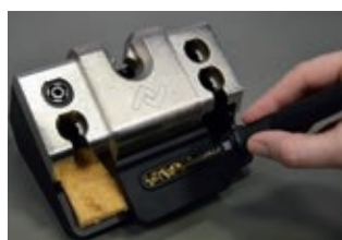
Il suffit de coller la pointe de soudure dans le nettoyeur à sec et de tourner
