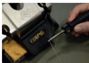
Ajouter une nouvelle soudure après le nettoyage
